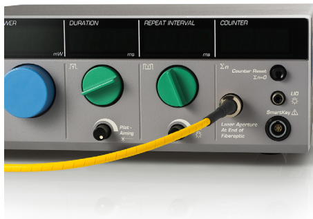
Conexión del cable de fibra óptica a la familia de consolas láser OcuLight
